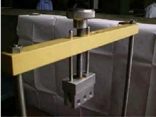
Figura 6. Detalhe da montagem do sistema de cargas, com o suporte superior com rolamento. Oficinas da PUC – MG.
