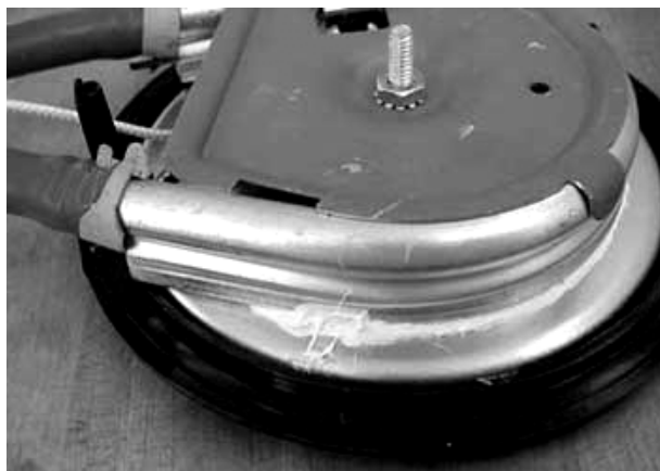
FIGURA 2 O ELEMENTO DE AQUECIMENTO E BASE [2]
