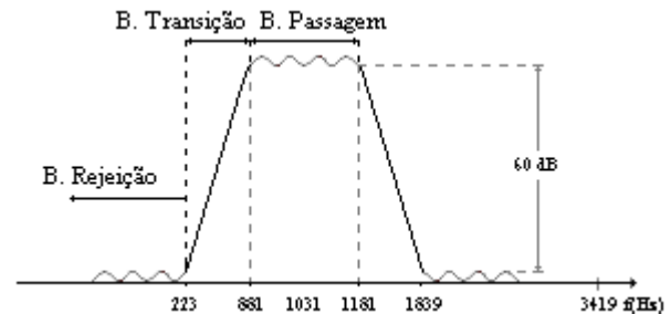
FIGURA. 2 ESPECIFICAÇÕES DO FILTRO PASSA-FAIXA DIGITAL FIR
