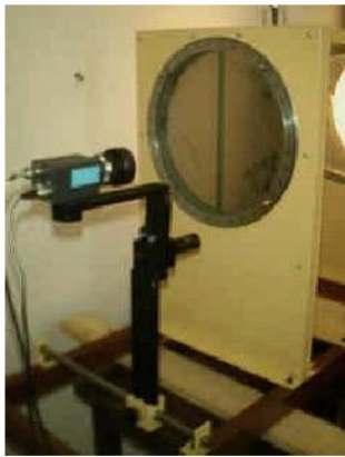
Figura 8. Montagem de uma câmera CCD, com seus dispositivos acessórios, na haste regulável do polariscópio
