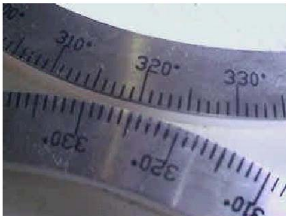
Figura 4. Anéis graduados, pré-montados com os anéis retentores das placas de onda e polarizadores.
