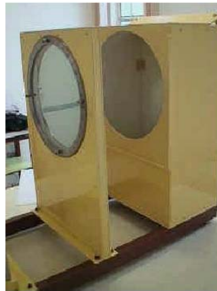
Figura 3. Detalhe da fonte de luz e sua montagem sobre as guias de fixação da base do conjunto, observando-se, na parte superior, a veneziana de ventilação.
