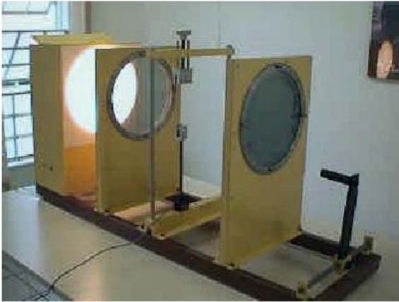
Figura 2 Polariscópio de transmissão modelo, construído nas oficinas do Instituto Politécnico da Pontifícia Universidade Católica de Minas Gerais.
