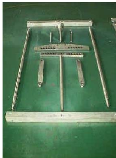
Figura 5. Acessórios do sistema de carga, com a configuração para ensaios de flexão pura
