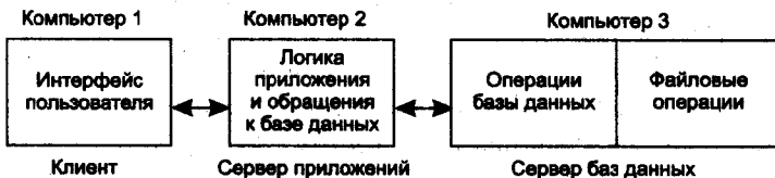
Рис. 10.2. Трехзвенная схема распределения частей приложения
