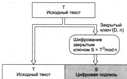
Рис. 12.11. Схема формирования цифровой подписи по алгоритму RSA
