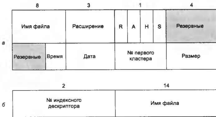
Рис. 7.8. Структура каталогов: а — структура записи каталога MS-DOS (32 байта), б — структура записи каталога ОС Unix
