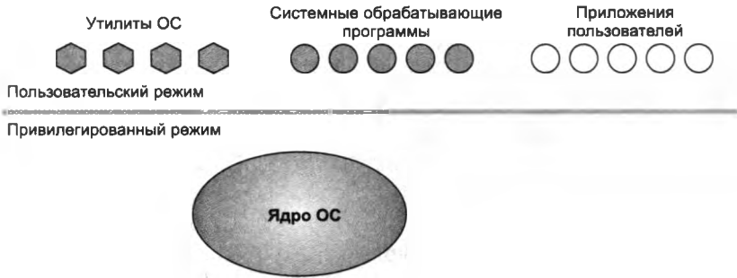
Рис. 3.3. Архитектура операционной системы с ядром в привилегированном режиме
