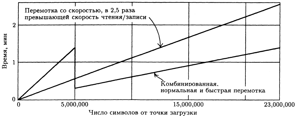
Рис. 82. Приблизительное время счета при двух обычно используемых методах перемотки.
