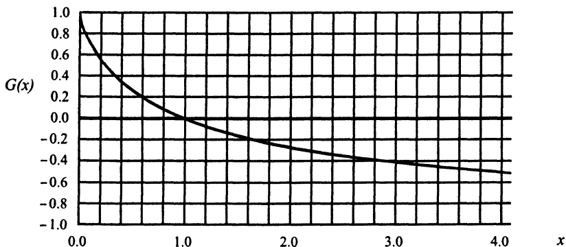
Рис. 10. Предельное распределение отношений в бинарном алгоритме вычисления наибольшего общего делителя.
