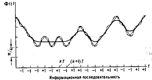
Рис. 3. Изменение фазы \Phi(t) при модуляции ММС (штриховая линия), ММС с синусоидальным сглаживанием (пунктирная линия) и УЧМ (сплошная линия).
