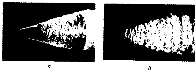
Рис. 8. Развитие турбулентности из спиральных вихрей, формирующихся в пограничном слое при обтекании вращающегося конуса: а) U = 1,7 м/с; n = 670 об/мин; б) U = 1,0 м/с; n = 1200 об/мин. Здесь U — скорость набегающего потока, n — частота вращения (R. Kobayashi, L. Kohama, M. Kurosawa, 1983).
