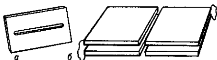
Рис. 8. Электростатические цилиндрические электронные линзы: а—диафрагма со щелью; б—иммерсионная линза, состоящая из двух пластин. В области прохождения заряженных частиц поле линз не изменяется в направлении, параллельном щелям диафрагм или зазорам между пластинами соседних электродов.
