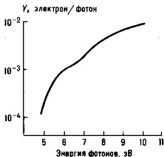
Рис. 2. Спектральная зависимость квантового выхода фотоэмиссии для сильнолегированного кремния n - и p -типов ( \epsilon_g = 1,1 эВ, \chi = 4 эВ); 1 — n -тип, 2 — p -тип.
