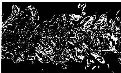
Рис. 7. Двумерное сечение струи, визуализированной красителем, флуоресцирующим в поле лазерного излучения. Число Рейнольдса Re = 4 \cdot 10^3 , изображенная область простирается от 8d до 24d ( d — диаметр струи) (K. R. Sreenivasan, 1991).
