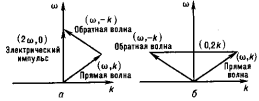
Рис. 3. Дисперсионные диаграммы, поясняющие образование двухимпульсного (а) и трёхимпульсного (б) электроакустического эха.
