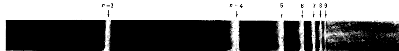
Рис. 1. Экситонный спектр поглощения \text{Cu}_2\text{O} (пластинки толщиной 60 мкм) при 4,2 К. Видны члены серии, начиная с n=3 ( \lambda = 573,5 нм).
