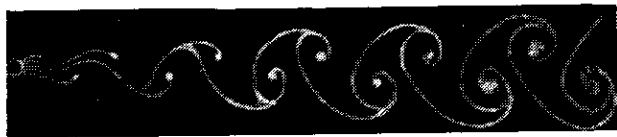
Рис. 10. Визуализация вихревой дорожки (для Re=73 ) с помощью частиц дыма.
