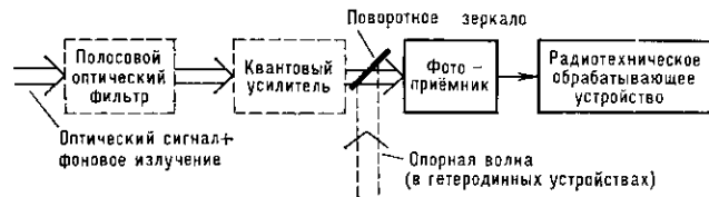
Рис. 1. Схема устройств прямого и гетеродинного детектирования.
