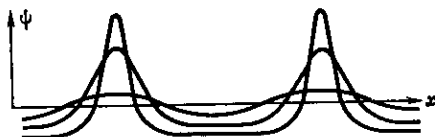
Рис. 17. Периодические стационарные волны различных амплитуд в нелинейной среде с дисперсией.
