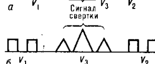
Рис. 7. Форма выходного сигнала V_3 при свёртке: а — двух прямоугольных и б — двух пар прямоугольных импульсов V_1 и V_2 .
